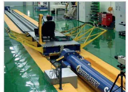
Dosierte Hochdruckluft bringt den Testschlitten mit dem Prüfdummy mächtig in Fahrt.
